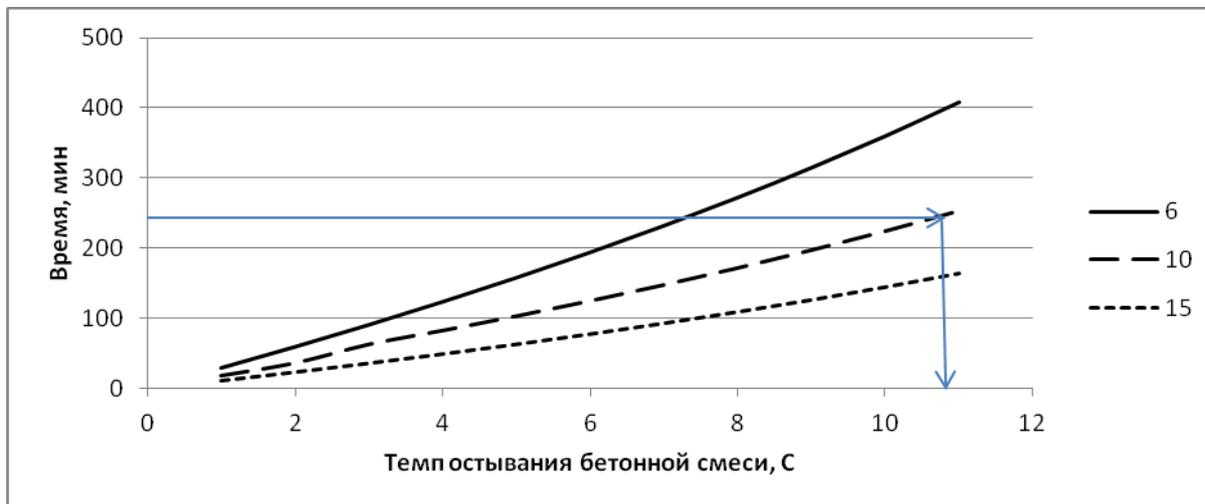
6, 10, 15 – массивность конструкции
