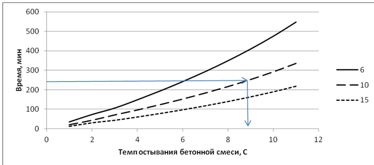
6, 10, 15 – массивность конструкции
