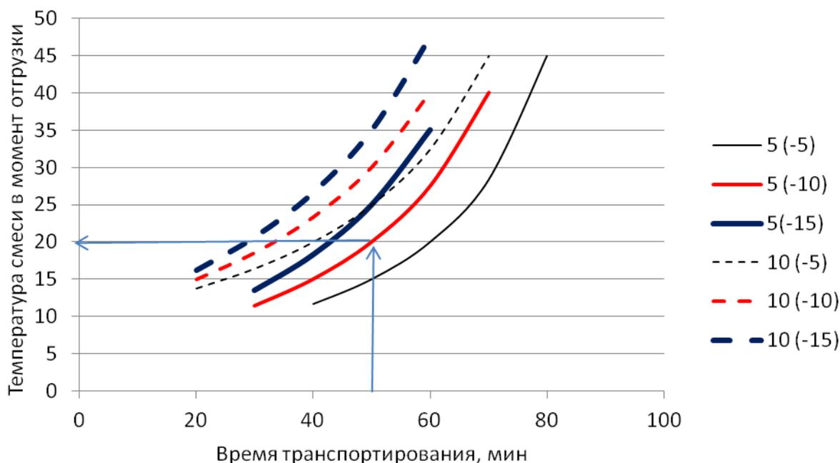
5 (-10) – соответственно 5 - температура бетонной смеси, °C, в момент укладки; (-10) - температура наружного воздуха, °C
